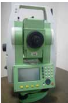
基準点と対象物との距離をレーザの反射時間で測る測量機器
